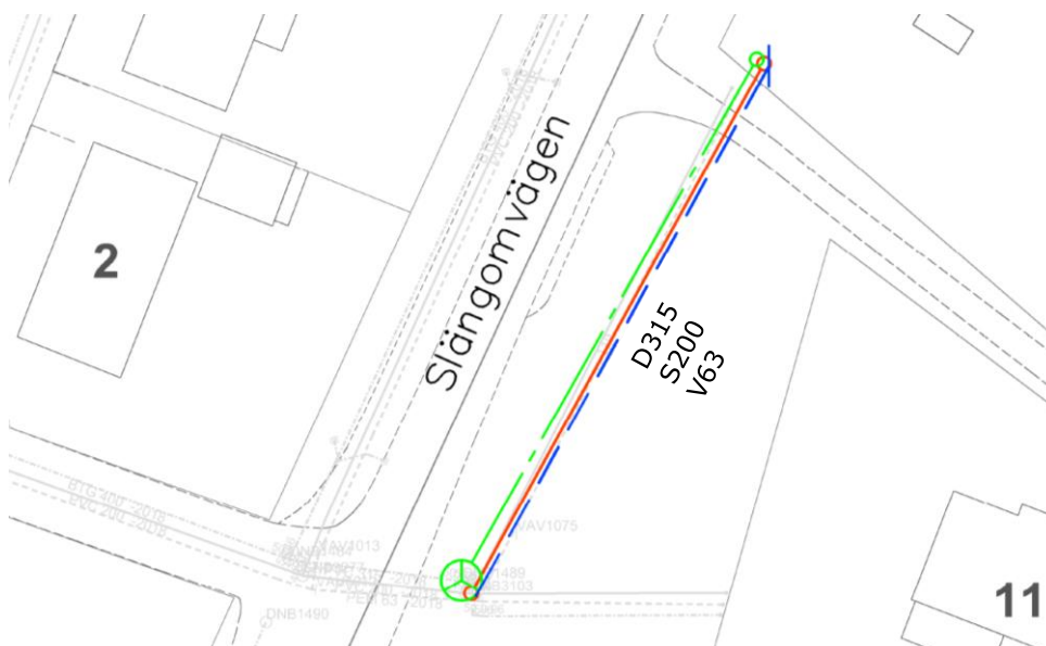
Figur 4: Föreslagna servisledningar samt påkoppling till befintligt nät.
